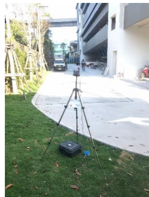
รูปที่ 17 การติดตั้งเครื่องตรวจวัดเสียงและสั่นสะเทือน
